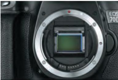
Auf dem LCD auf der Oberseite werden zusätzliche Einstellungen angezeigt. Der neue 20,2-Megapixel-Sensor im APS-C-Format nutzt eine neuartige CMOS-Sensor-Architektur.
