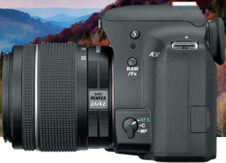
Das mit Kunststoff überzogene, abgedichtete Edelstahlgehäuse trotz Schmutz und Kälte bis zu -10 Grad. Über die frei belegbare Spezialtaste oben links lässt sich schnell ins DNG/RAW-Format wechseln.
